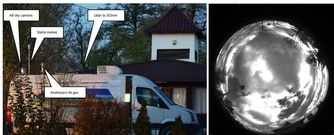
Fig.5 (stânga) Camera de monitorizare a acoperirii noroase instalate pe laboratorul mobil în timpul campaniei experimentale pentru măsurarea caracteristicilor norilor în atmosfera reală, Câmpina, 2016; (dreapta) instantaneu all-sky-camera din timpul campaniei
